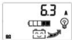
Aktuell förbrukning (Lågspänningsuttaget)
