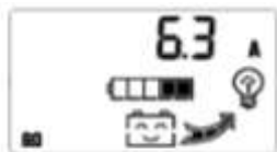
Aktuell förbrukning (Lågspänningsuttaget)
